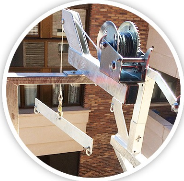
Soporte de montaje con torno manual y balancín
