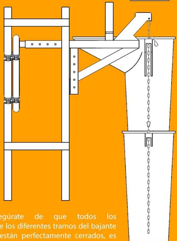
El fabricante del bajante de escombros DROMADER recomienda por la seguridad la instalación de soporte de fijación principal y los soportes de fijación intermedios cada 15 diferentes tramos en la columna del bajante de escombros para evitar sobrecarga y posible rotura de los ganchos integrados, mosquetones o cadenas.
